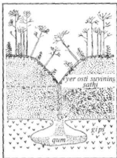
10-rasm. Yer ostidagi karst bo'shliqlarining o'pirilishidan kelib chiqqan karst varonkalari.
